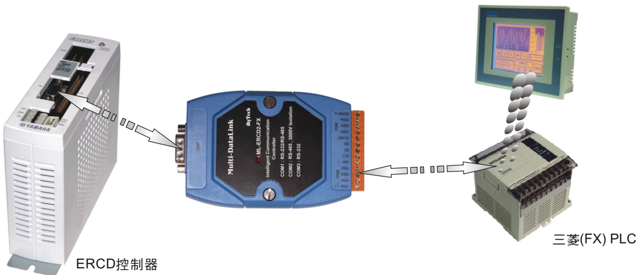
(a). ERCD單軸控制器 與 MLink (Com1/RS232) 接線圖
