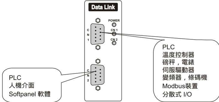
特色：GE-CMM311 (Modbus-Slave) 裝置，透過資料交換器(DataLink)與儀錶MA-SRT連線，不需要撰寫任何通訊程式，就可以讀取儀錶的目前累積量值及瞬間量值資料。
