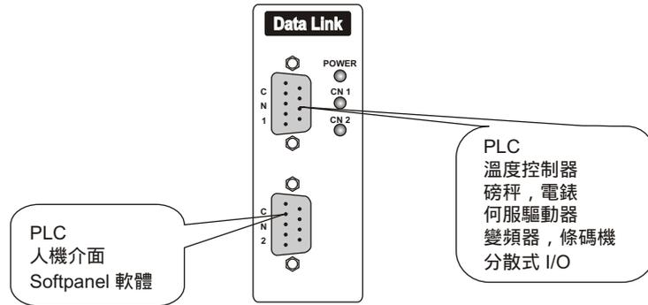
特色：三菱 PLC，A1SJ71UC24-R2 / QJ71C24，透過資料交換器與NT-482溫度控制器連線，不需要撰寫任何通訊程式，竟而達到控制溫度表的設定值及顯示現在值 (PID功能，Relay輸出，SSR輸出，類比輸出，全部交給溫度表做控制)。
