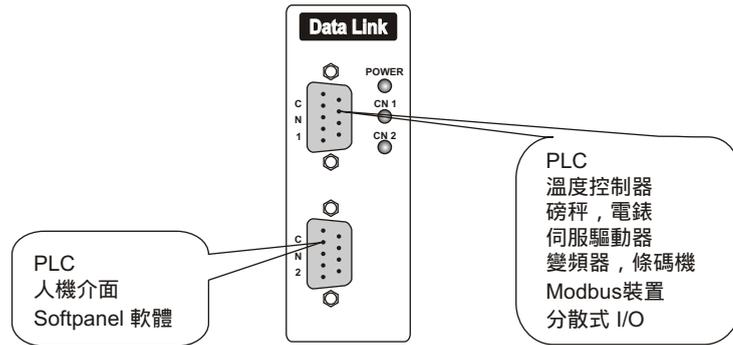
特色：豐煒 PLC (M,VB系列)，利用通訊埠，透過資料交換器與Modbus(RTU)裝置連線，PLC只需要做簡單的設定，不必撰寫任何通訊程式，竟而達到讀取或寫入Modbus裝置的資料。
