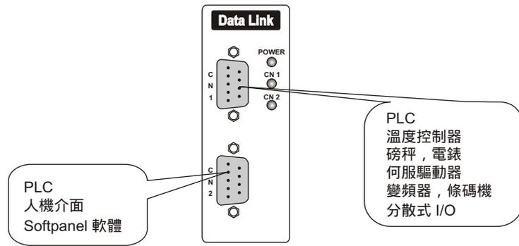
特色：三菱 PLC, A1SJ71UC24-R2 / QJ71C24, 透過資料交換器與三菱變頻器通訊埠連線, 不需要撰寫任何通訊程式, 竟而達到控制變頻器的高速/低速及顯示輸出頻率。
