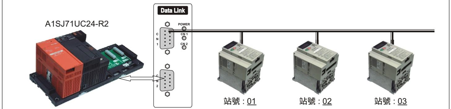
應用例二. 三菱 PLC(FX 系列), 透過資料交換器與溫度控制器連線, 不需要撰寫任何通訊程式, 竟而達到控制溫度表的設定值及顯示現在值(PID 功能, Relay 輸出, SSR 輸出, 類比輸出, 全部交給溫度表做控制)。
