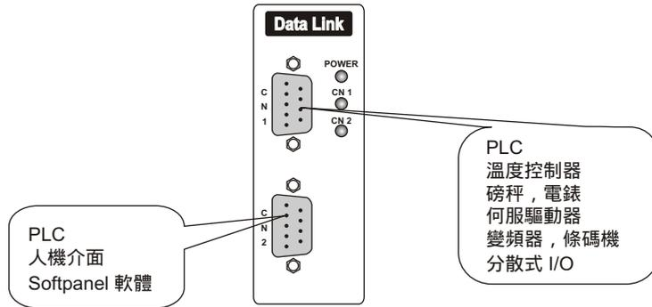
特色：三菱 PLC，A1SJ71UC24-R2 / QJ71C24，透過資料交換器與MT-C9-600R計數器連線，不需要撰寫任何通訊程式，竟而達到讀取計數器目前資料。
