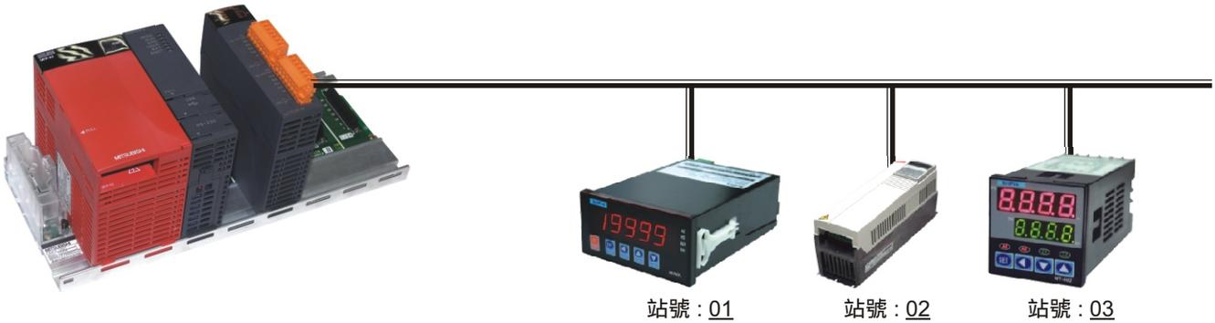
特色：Qcpu 內建 Modbus\_RTU 通訊程式，經由 QJ71C24 可以和 Modbus 裝置溝通，使用者只要設定暫存器中的站號、裝置的參數位址及讀寫資料，不用去了解複雜的通訊協定格式。並提供通訊愈時、延遲時間、異常重試次數以及通訊狀態，每個狀況都在您的掌握之中，讓您輕輕鬆鬆的完成 Modbus 裝置通訊控制。
