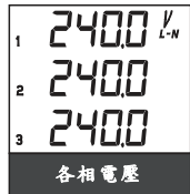
相電壓、頻率 顯示畫面
